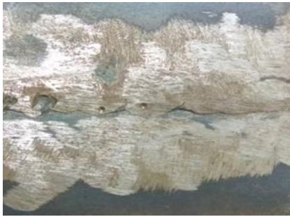
(d) Gas welded steel sheet (Hot Rolled & Cold Rolled)
